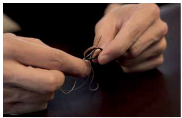
Die RIOS1931-Verriegelungsnaht an der SchlieÙe, von Hand vernäht und von innen im Dornloch verknottet. The RIOS1931 locking stitching at the buckle, hand-sewn and knotted on the inside through a pin hole.
